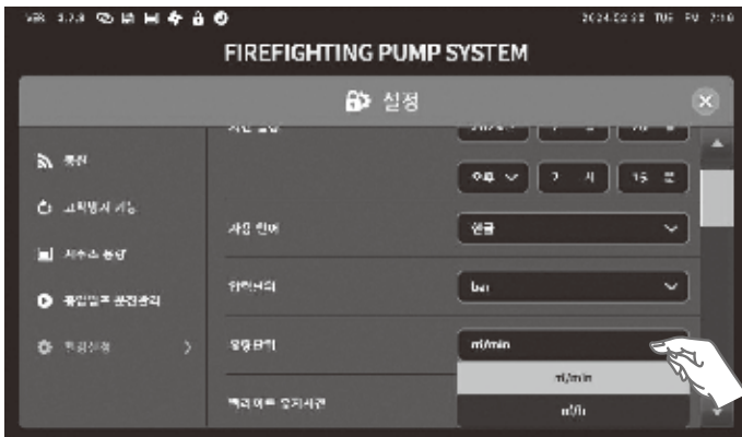
- 유량단위 설정값을 선택하고 OK 버튼을 터치합니다. ※ 사용 가능한 유량단위에는 m 3 /min, m 3 /h 입니다.
