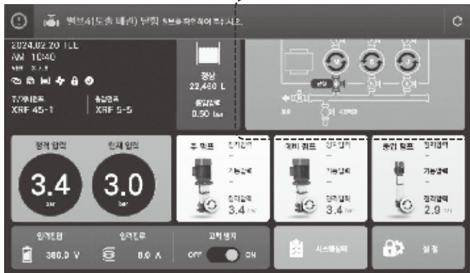
- 정상적으로 시스템이 작동 할 수 없는 이상 경보 발생 ② 밸브닫힘 발생 : MAIN 화면 상단에 점멸 ※ MAIN 화면 밸브의 개폐상태에서도 확인 가능
