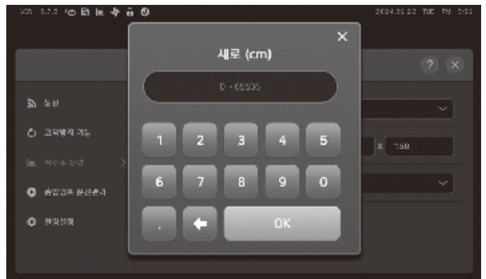
- 가로 X 세로 (cm) 설정값을 선택하고 입력창이 나오면 실제 현장의 수조 길이(세로)를 입력하고 OK 버튼을 터치합니다. ※ 현장의 수조 길이를 모두 입력하게 되면 자동으로 용량이 계산되어 MAIN 화면 저수조 용량에 표시됩니다.
